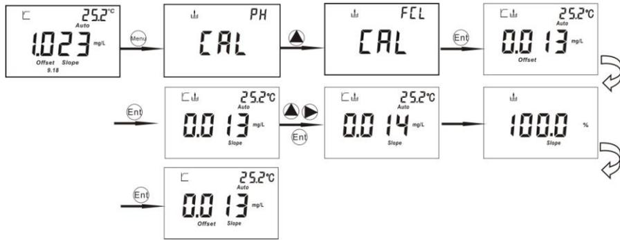
如上图所示；在测量模式按 Menu 键再按上键即可进入余氯校准提示画面，按 Ent 键确认进入校准流程(CAL)。
