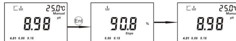
屏幕中电极图标和 2 个未校准过的标准值不停闪烁，提示用户可以校准相应的标准值。将电极放入标准溶液中，待数据稳定后按 Ent 确认，仪表会显示电极斜率画面。然后进入下一个校准循环进行第 3 点校准，步骤如下：
