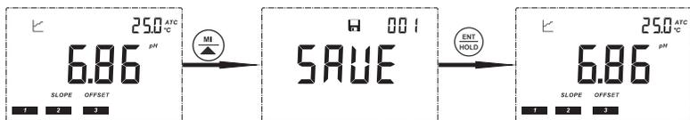
1. 在测量数据稳定后用户如需要保存, 按 **M** 键在仪表的上方会显示 **H** 符号并在左上方显示保存数据的批次, 然后按 **ENT/HOLD** 键确认保存此数据, 也可以按 **ENT/HOLD** 键不保存返回测量模式。保存完成后仪表会自动返回到测量状态。数据最多可保存256组, 如超出仪表会显示“OVER”表示存储器已满。
