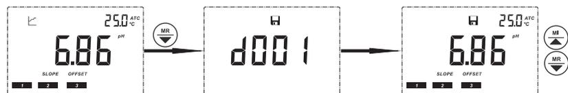
1. 在测量状态用户按 **MR** 键进入保存数据的浏览, 首先显示出保存数据的批次, 然后再显示这批次的数据, 在这状态下用户可以按 **M** 键或 **MR** 键查看保存的所有数据。按 **ENT/HOLD** 键为退回到测量状态。如显示“NONE”表示存储器内没有数据。
