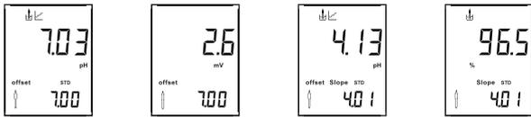
第一点为零点校准（6.86或7.00），将电极头置入标准液中，待数据稳定后会出现数据稳定符号，后仪表将自动校准，完成后会显示零点校准的偏移量并进入下一个校准点这时用户可以任意校准其它两点。校准其它两点时仪表也会进行自动校准，若出错仪表会显示ERR作为提示，并且重新进入该点的校准。若三点全部校准完成仪表会自动回到测量模式，用户也可以按
